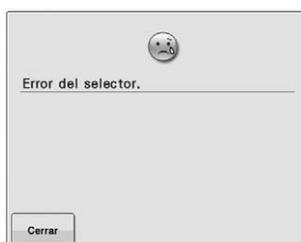
El colector del hilo no funciona correctamente. Retire el hilo enredado en el colector del hilo.
