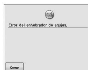
El mecanismo de enhebrado automático no funciona correctamente. Retire el hilo enredado en el mecanismo de enhebrado automático y, a continuación, toque
