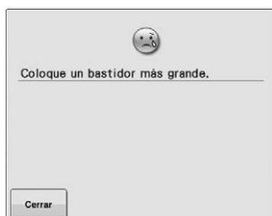
Es posible que aparezca un mensaje que indique que el bastidor de bordado se sustituirá, aunque no se haya instalado ningún bastidor de bordado. La máquina de bordar detecta qué bastidor de bordado está instalado según la posición del brazo izquierdo del soporte del bastidor de bordado. Por tanto, el tamaño del bastidor se determina por la posición del brazo izquierdo, incluso si el bastidor no está instalado realmente.
