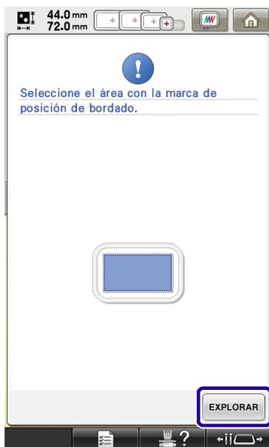
→ La cámara detecta los dos adhesivos de posición.
